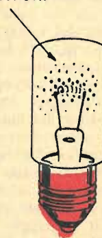
Fig. 2 - Anche i filamenti delle comuni lampade per illuminazione risultano avvolti da una invisibile nube di elettroni, la cui fuoriuscita dal metallo che compone il filamento è provocata dalla elevata temperatura di quest'ultimo.
