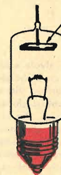
Fig. 3 - Una comune lampadina può divenire un diodo se in essa viene inserita una placca metallica fornita di un conduttore comunicante con l'esterno.
